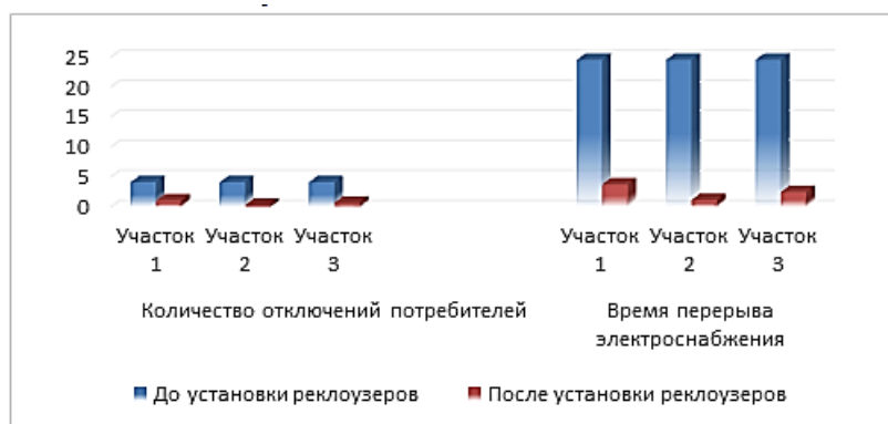
Рис. 6. График сравнения количества отключений потребителей и времени перерыва электроснабжения схемы радиального фидера с ответственным потребителем
