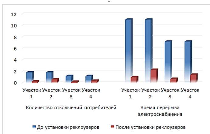
Рис. 4. График сравнения количества отключений потребителей и времени перерыва электроснабжения схемы кольцевого фидера
