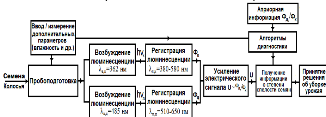
Рисунок 3 – Структурная схема методики определения спелости семян сельскохозяйственных растений
