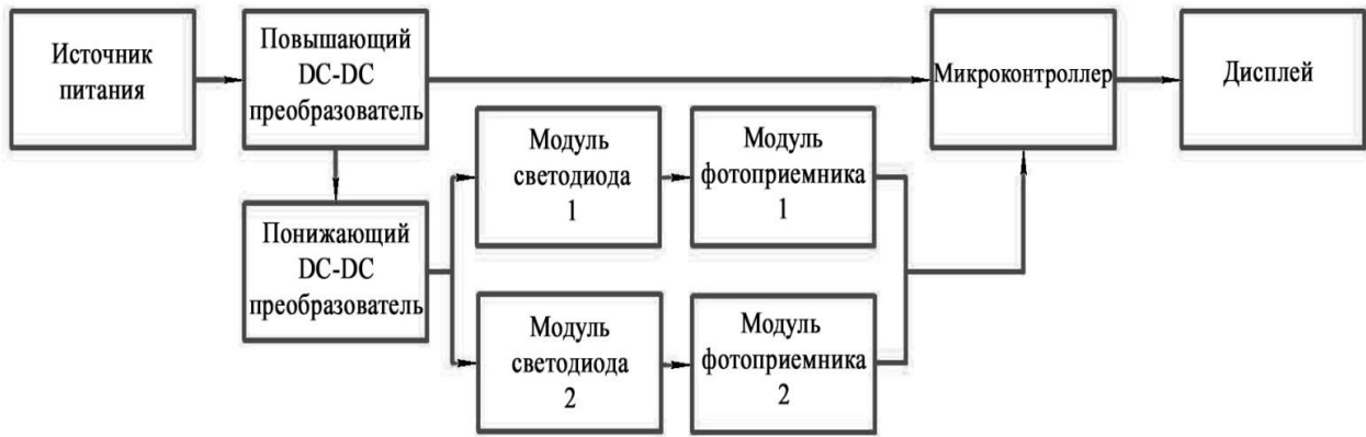
Рисунок 4 – Структурная схема устройства мониторинга спелости семян сельскохозяйственных растений
