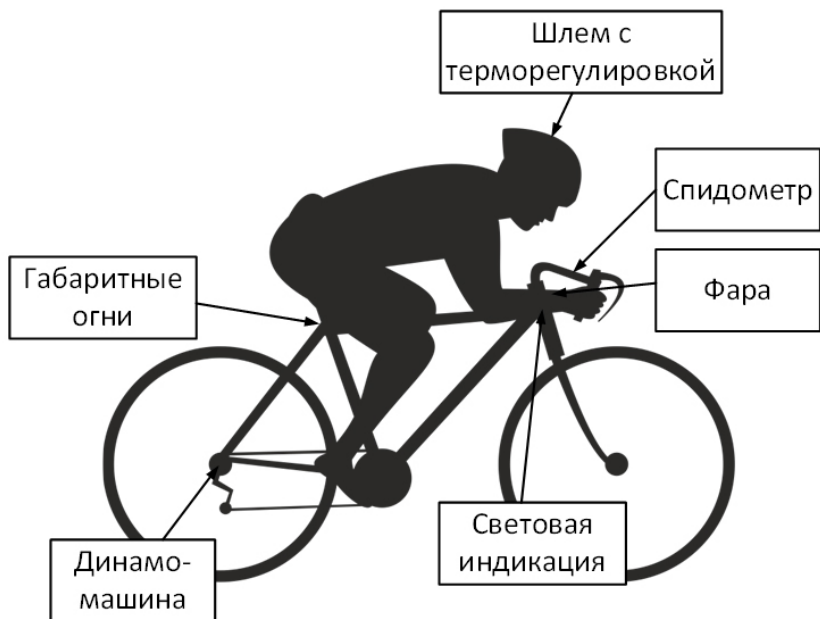
Рис. 1. Схема велосипедного комплекса «ББ-1»
