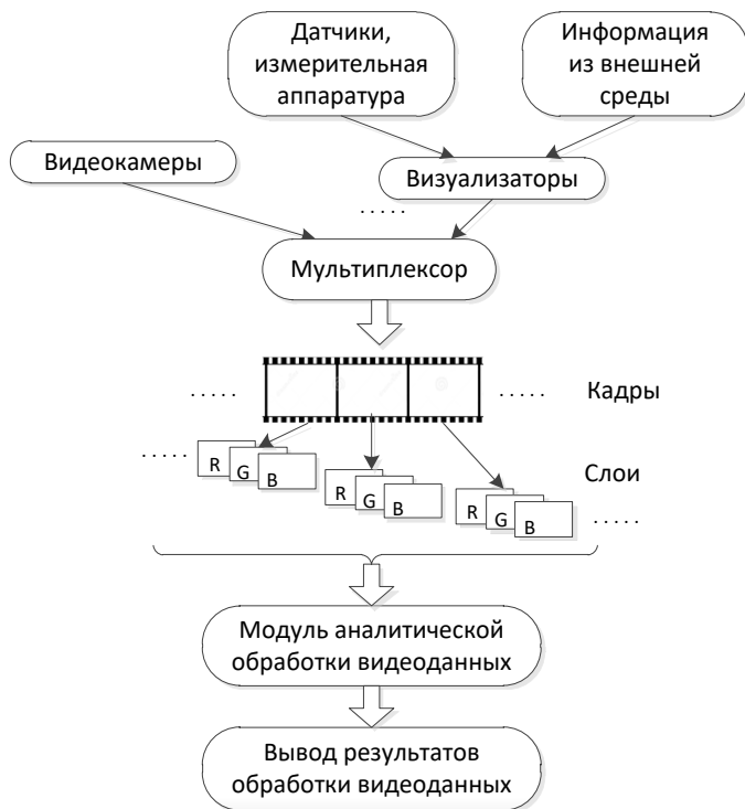
Рисунок 2 – Структура обработки данных в системе «умный дом» Информация с видеокамер, установленных в различных местах контролируемого
